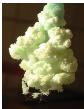
Takie kryształy powstaną gdy woda będzie parowała zbyt szybko
